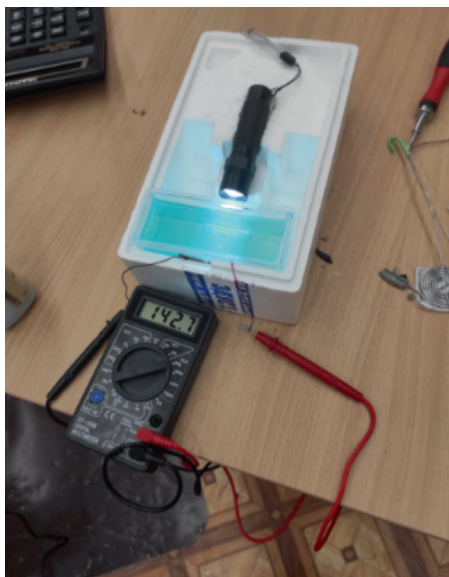
1- Лампа; 2- Светофильтр; 3- Кювета для растворов; 4-Фотоприёмник; 5 – устройство измерительное (мультиметр).
