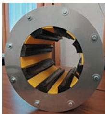
Рис. 1. Общий вид подшипника с антифрикционным материалом из древесины
