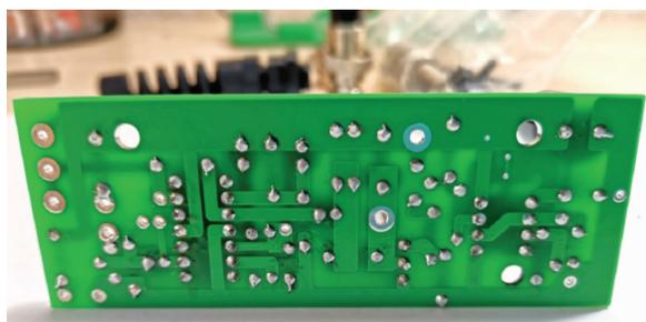
4. Был осуществлен монтаж выводных компонентов: Переменные резисторы, Динамик, Холдер (Держатель) для элемента питания – кроны, в дальнейшем заменённой на аккумулятор 18650, подключённый через повышающий модуль.
