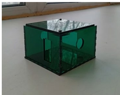
Рисунок 6. Корпус из акрилового пластика
