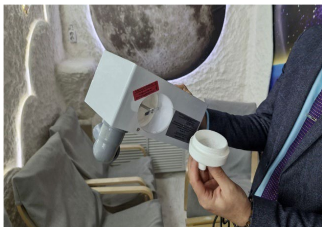
Фото 2. Резервуар для засыпки соли
