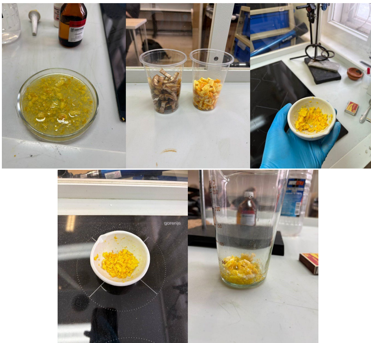
Рисунок 3.1 – Синтез биопластика на основе апельсиновой кожуры
