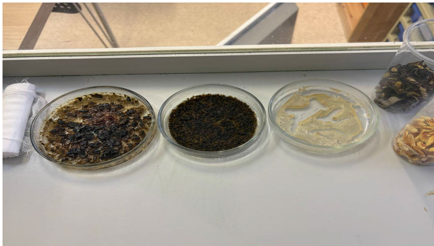
Рисунок 3.2 – Образцы биополимеров на основе апельсиновой и банановой кожуры
