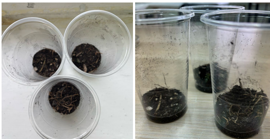
Рисунок 3.6 – Тест на биodeградацию биопластиков из разных пищевых отходов
