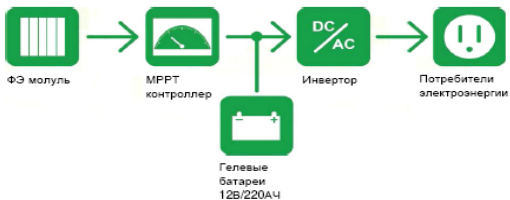
Рисунок 7. Комплект солнечной электростанции Bekar Ready Kit, 3 кВт.
