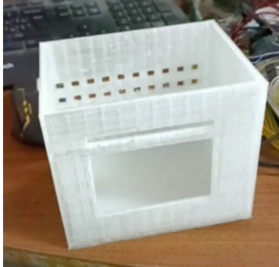
Рисунок 11. Внешний вид корпуса ИИС, напечатанного на 3D принтере
