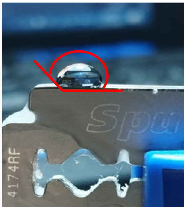
Рис. 7. Угол смачивания на самодельной поверхности
