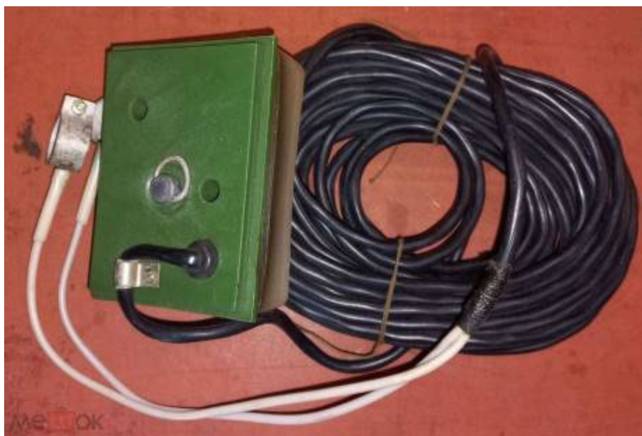
Рисунок 2. Делитель напряжения для подключения прибора к автомобильному аккумулятору
