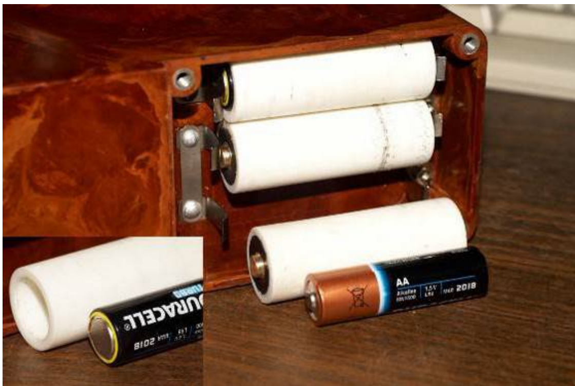
Рисунок 9. Фотография готовых переходников, изготовленных по чертежу рис.5
