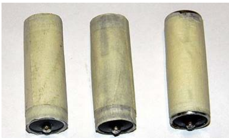
Рисунок 7. Элементы R12, обернутые малярным скотчем
